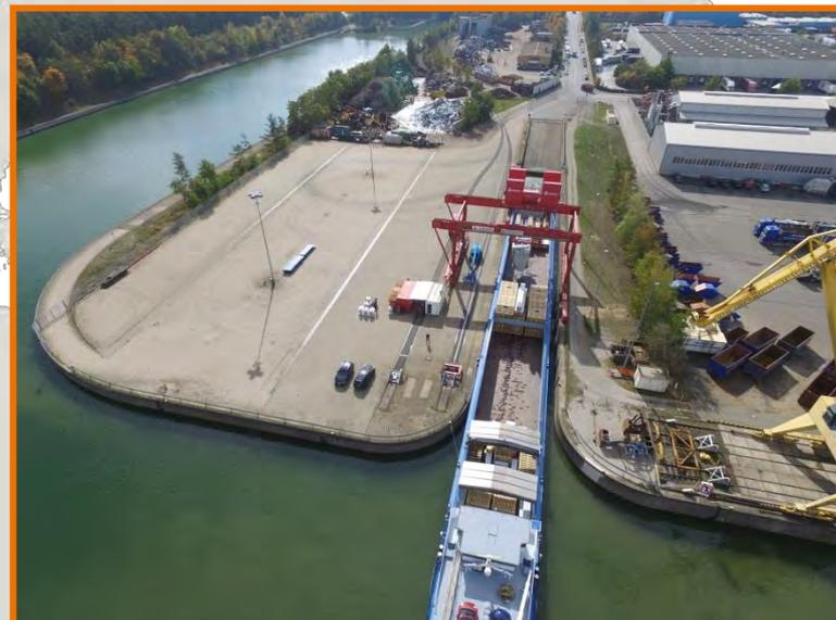
Стационарно установленная система козловых кранов грузоподъемностью 600 тонн, эксклюзивная компания по обработке тяжелых грузов в «Байернхафене», Нюрнберг, складские помещения площадью 12 000 кв. 30 тонн / кв.м.
